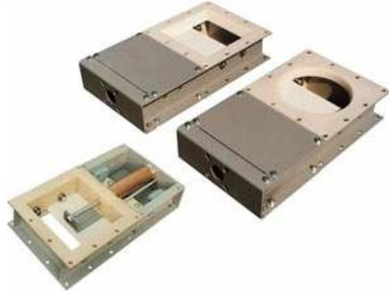
Se utilizan las válvulas guillotinas VL cuando el flujo de un material sólido está causado por la gravedad o que el transporte tiene que ser interceptado. Las válvulas se pueden colocar a la salida de tolvas o silos, a las entradas y salidas de transportadores mecánicos y a la entrada de descargadores telescópicos. Para las salidas de transportadores, la versión VLS con el actuador neumático integrado es una opción válida debido a las dimensiones de la válvula.
